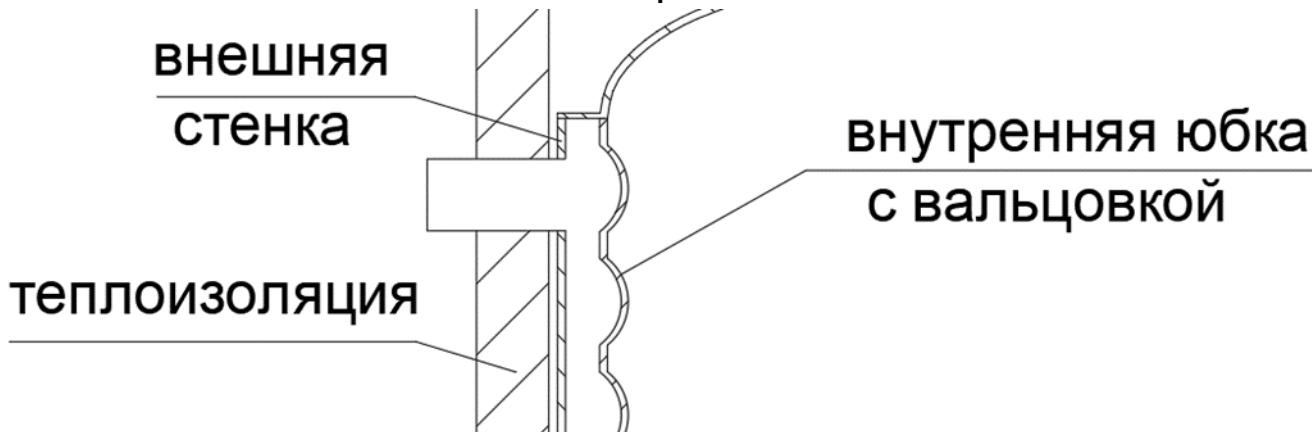
2.1. Бойлер FB INOX Premium сконструирован по схеме внутренний бак бойлера (контура горячего водяного снабжения (далее ГВС) с водяной юбкой (контура обогрева бойлера через систему отопления (далее СО). Для повышения производительности внутри водяной юбки предусмотрены направляющие потока воды. Для увеличения прочности, внутренние стенки имеют вальцовку.
